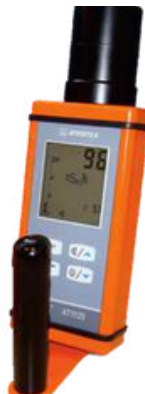
Surveimeter X-Ray dengan detektor NaI (TI) jendela tipis Cadmium buatan Atomtex – Belarusia
